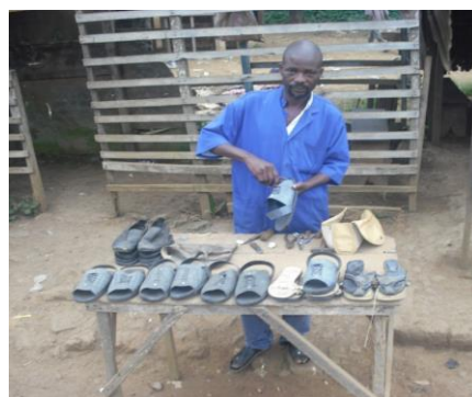
Photo n°2 : Fabrication des sandales à Mouyondzi à partir des vieux pneus récupérés. Cliché Kinouani, 2009
